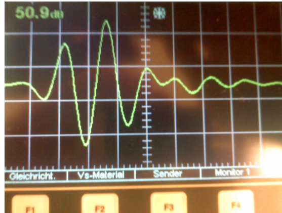
Abbildung 1: Prüfkopf S10W2C: Empfangenes Signal (1. Echo).
